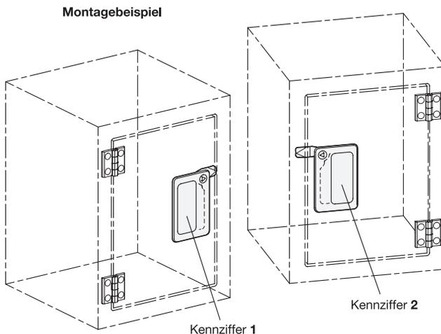
Zur Montage wird die Tür bzw. Klappe oder Luke mit einer Ausnehmung gemäß Skizze versehen.
