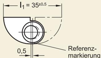
Zum Ausrichten der Türe kann der Exzenterstift des oberen und unteren Scharnieres in die erforderliche Position gedreht werden.
