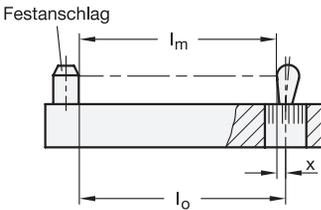
Bei Beachtung obiger Angaben ist gewährleistet, dass der gesamte Verstellweg des Seitendruckstückes zum Ausgleich der Werkstücktoleranz zur Verfügung steht.
