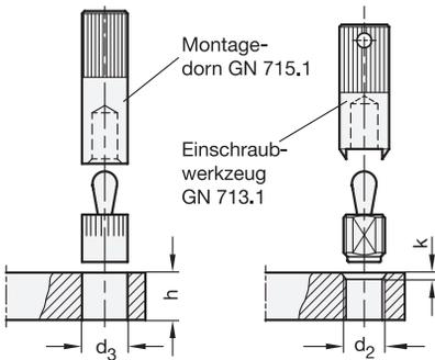
Zur Montage der Seitendruckstücke empfiehlt sich die Verwendung von Montagedornen GN 715.1 bzw. Einschraubwerkzeugen GN 713.1.
