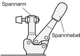
Durch die Anwendung des **Kniehebelprinzips** weisen Schnellspanner entscheidende Vorteile auf:
