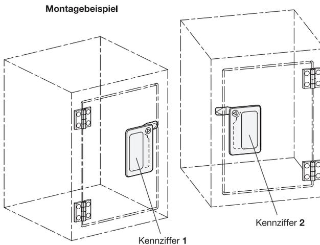
Zur Montage wird die Tür bzw. Klappe oder Luke mit einer Ausnehmung gemäß Skizze versehen.
