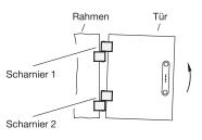
Scharnier 1: Stift im Uhrzeigersinn drehen Scharnier 2: Stift im Gegenuhrzeigersinn drehen
