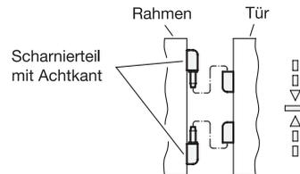
Die Montage des oberen Scharnierteiles am Rahmen ist erst nach dem Einhängen des unteren Scharnieres möglich.
