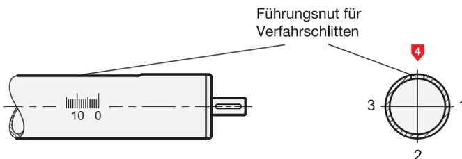
Mit den Kennziffern 1, 2 oder 3 wird die Lage der Skala im Bezug auf die Führungsnute festgelegt.
