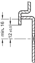
Mit diesen Schnappverschlüssen kann eine Tür bzw. Klappe oder Luke verriegelt, jedoch nicht geklemmt werden.
