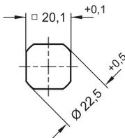
Die benötigte Montagebohrung im Türblatt wird in der Serienfertigung üblicherweise durch Stanzen oder Lasern erzeugt.
