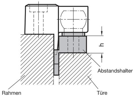
Für Anwendungsfälle, bei denen die Türe nicht gleich hoch wie der Rahmen ist, stehen Abstandshalter GN 450.1 mit der Höhe  $h = 5, 10$  und  $15$  mm zur Verfügung.
