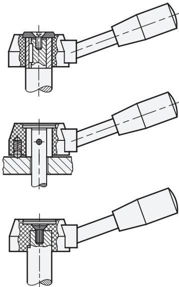
Schalthebel GN 512 befestigt mit Nabennut / Passfeder, unter Verwendung von Vorlegescheibe GN 184 → Seite 1090.
