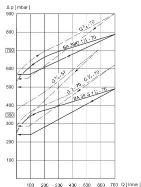
Druckverlauf  $\Delta p$  [mbar] im Behälter in Abhängigkeit vom Luftdurchsatz [l/min.] bei Ventilöffnungsdruck 350 bzw. 700 mbar.
