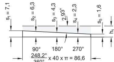
Auf den Zeichnungen ist beispielhaft die Form KV mit Spannrichtung R (durch Rechtsdrehung) dargestellt.
