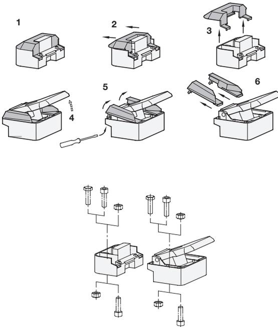
Vor der Montage müssen die Abdeckungen des Fallenverschlusses gemäß der Skizze demontiert werden. Zur Befestigung können z. B. Zylinderschrauben DIN 912, Sechskantschrauben DIN 933 sowie Sechskantmuttern ISO 4032 jeweils in der Gewindegröße M 6 verwendet werden.
